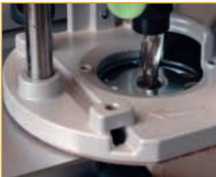
Spannen Sie ein Werkstück wie in Bild 2, bzw. 3 Seite 13 ein, senken Sie den Fräser auf die Stirnholzfläche ab, arretieren Sie das Motorgehäuse mit dem Drehgriff.
