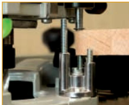
Legen Sie ein Werkstück auf eine Revolveranschlagschraube und senken Sie den Tiefenanschlag auf das Werkstück, Tiefenanschlag jetzt mit Feststellhebel klemmen.
