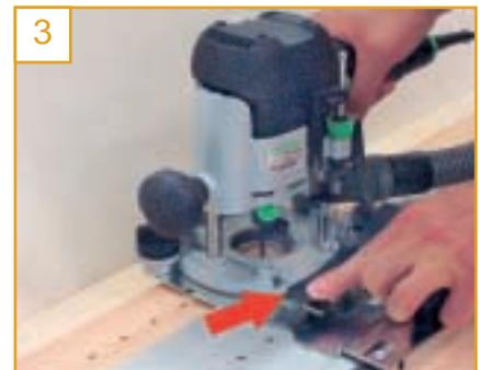
Der Bolzen der Führungsplatte muß immer in die Bohrung der Führungsschiene einrasten. Er wird durch Drücken des Hebelarmes nach oben bewegt. Der Bohrer bohrt neben der Schiene
