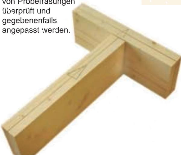
Üblicherweise erhalten bei Schubkästen die Seitenstücke die Schwalben, das Vorder- und Hinterstück die Zinken. Treffen Sie die Holz Auswahl und bringen Sie die Werkzeichen an.
