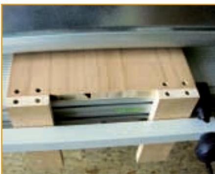
Die Korpusseiten oben werden anstelle eines oberen Bodens mit Traversen verbunden. Die vordere Traverse an der Vorderkante der Seite ausrichten, die hintere Traverse an der hinteren Kante der Seite ausrichten.
