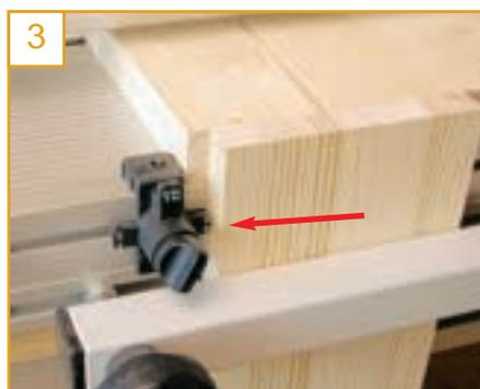
Das Werkstück welches die versetzten Zinken erhält, wird am Drehanschlag mit der Bezeichnung FZ10 angelegt. Dadurch wird exakt der erforderliche Zinkenversatz erreicht, der eine bündige Korpusecke ermöglicht.
