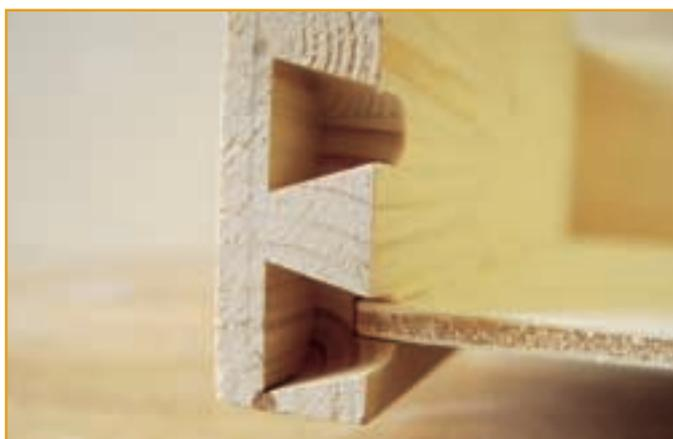
Die Nut für Boden/Rückwand kann in allen Teilen durchgefräst werden. Die Position der Nut muss zwischen zwei Zinken sein, damit sie von der Schwalbe verdeckt wird.
