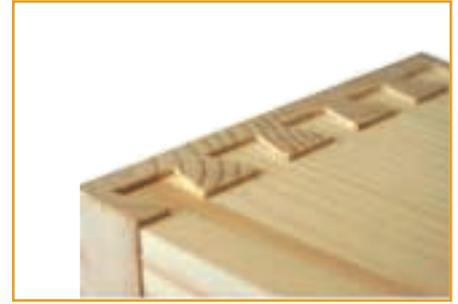
aller Regel dürften die Veränderungen nur wenige 1/10 mm betragen. Führen Sie nach der geänderten Einstellung unbedingt noch eine Probefräsung durch. Die Holzdicke der Probestücke entsprechen denen der Originalwerkstücke!
