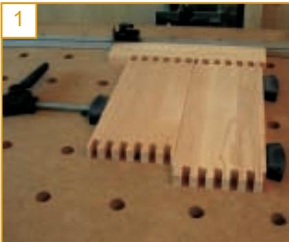
Der Schubkasten erhält einen einguteneten Boden aus Furnierplatte. Die Nut soll an keiner Stelle sichtbar sein, deshalb darf sie an den Seiten nicht durchgefärdt werden, an denen die Nut durch die Zinken verläuft. Die Oberfräse wird entweder mit dem Seitenanschlag oder - das stellen wir hier vor - mit der Führungsschiene am Multifunktions-tisch (MFT) geführt. Dieser ermöglicht exakte reproduzierbare Einspannposi-
