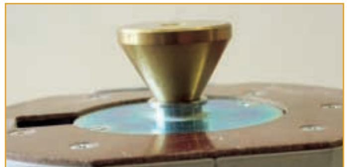
Bild oben: Vorbereitung der Oberfräse. Bei Verwendung der OF 1010 müssen immer zuerst die Kopierringe mit Hilfe eines Kegels zentriert werden! Verwenden Sie zum Anschrauben der Kopierringe die beiliegenden Zylinderkopfschrauben. Bei der OF 1400 ist das Zentrieren nicht mehr erforderlich, die werkzeuglose Aufnahme ist bereits zentriert. Setzen Sie anschließend den zur Schablone passenden Fräser ein.
