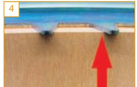
Die Zinkenschablone liegt direkt auf dem Werkstück auf. Heben Sie beim Fräsen die Oberfräse auf keinen Fall an, der Fräser zerstört sofort die Schablone!
