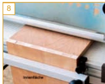
Klappen Sie das Werkstück, das die Bohrung ins Stirnholz erhält, nach unten (Innenfläche ist außen). Die Flächen, in die gebohrt wird, zeigen beide nach oben und werden bündig ausgerichtet. Die Werkstücke liegen seitlich am Anschlag an. Werkstücke mit Druckbalken festspannen.
