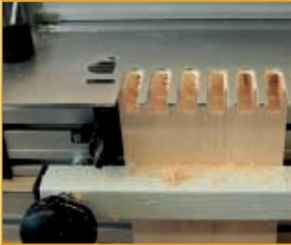
Die Werkstücke können beim Fingerzinken in der Regel alle am linken oder rechten Anschlag gefräst werden. Beim Hineinfräsen entstehen an den vorderen Kanten kaum Ausrisse, die hinteren Kanten werden durch das Splitterholz vor Ausrissen geschützt. Als Wiederholung: Alle vorderen, bzw. oberen Schmalflächen werden am Anschlag
