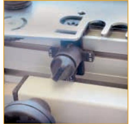
Die verstellbaren Anschläge an der Front des Grundgestelles in die mit einem Pfeil gekennzeichneten Aussparungen der Schablone so verschieben, dass die Pfeilmarkierungen der Anschläge an den geraden Kanten der Aussparung der Frässhablone anliegen. Je nach verwendeter Schablone die drehbaren Seitenanschlüsse auf "SZ 14" oder "SZ 20" stellen. Sie zeigen zur Mitte der Grundeinheit.
