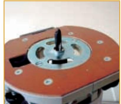
Die Oberfräse wird mit dem der Schablone DS 32 beiliegenden Kopierring ausgestattet. In unserem ersten Beispiel verwenden wir 8 mm Dübel, entsprechend dem Dübeldurchmesser wird ein Dübelbohrer mit ebenfalls 8 mm Durchmesser eingespannt.
