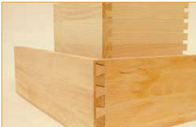
Die Länge und die Abstände (Teilung) der Schwalben ist durch die Frässhablone festgelegt. Festool bietet deshalb zwei verschiedene Frässhablonen für das Verbindungssystem VS 600 an. Die Auswahl der Schablonen ist abhängig von der verwendeten Holzdicke:
