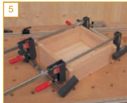
gesetzt und diese fest in die Brüstungsfläche gedrückt werden (Bild 6). Abschließend den Stich messen (Bild 7). Ca. 30 Minuten eingespannt lassen, dann können die Flächen bündig geschliffen oder gehobelt werden. Zum Bündigschleifen ist ein Bandschleifer ideal. Das Schleifband soll sich von der Ecke zur Brettfläche hin bewegen, nicht umgekehrt, dadurch
