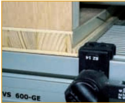
Ist bereits ein Rückwandfalz vorhanden, wird die Traverse am Falz ausgerichtet. Ein Foto des fertiges Objektes sehen Sie auf Seite 22 oben links.
