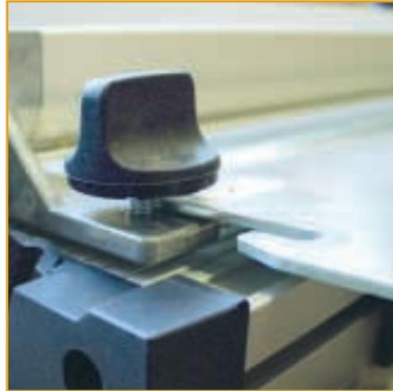
Die Schablone in die abgesenkte Halterung schieben. (Die Halterung ist auf Mittelstellung. Der Schwenkmechanismus wird nur beim Dübeln verwendet!) Die schwarzen Exzenteranschlüsse an der Schablone zeigen nach unten. Sie müssen an der Grundeinheit anliegen. Die Schablone kann etwas durchgebogen sein, bitte ganz in die Halterung einschieben.
