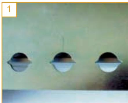
Die Dübelschablone besitzt an ihrer Unterseite Exzenteranschlüge. Das Einsetzen erfolgt nach dem bereits bekannten Prozedere. Die Bohrungen zur Aufnahme des Kopierringes sind nicht exakt kreisrund, es sind Kerben vorhanden die parallel zur Vorderkante der VS 600 zeigen. Diese Kerben stellen die Bohrmitte der Dübelbohrungen dar. Überprüfen Sie den parallelen Abstand der Schablone zur vorderen Kante des Grundgestells. Ist dieser Abstand nicht parallel, dann bitte die Schablone ausrichten.
