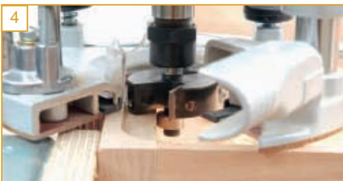
Festool bietet ein HW-Wendepplatten-Falzfräser-Set mit einem Durchmesser von 31,7 mm inklusive 5 verschiedenen Anlaufringen an. Damit können durch Auswechseln des Anlaufringes mit dem gleichen Falzfräser Falzbreiten von 8,0, 9,5, 11,0, 12,6 und 14,6 mm erreicht werden.
