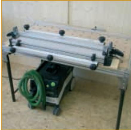
Spannen Sie die Grundeinheit VS 600 auf einen stabilen Werk Tisch. Ein Absauger sollte möglichst vorhanden sein, um ein gesundheitsschonendes Arbeiten zu ermöglichen.
