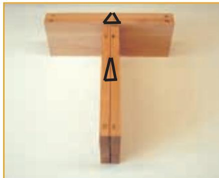
ßend die Werkzeichen an. Die Spitze des Dreiecks zeigt zum Vorderstück. Die Seiten erhalten an den Ecken die durchgehenden Eckzinken, deshalb schreiben Sie an den Enden der Seiten ein "D". Die Vorder- und Hinterstücke erhalten dann die versetzten Eckzinke, markieren sie diese mit einem "V". Die Markierungen
