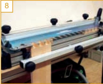
Die Werkstücke werden senkrecht entweder am linken oder rechten Seitenanschlag eingespannt. Die Werkzeiche zeigen zum jeweiligen
