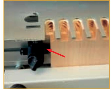
Oben sehen Sie den quergestellten Drehanschlag mit der Bezeichnung FZ 10. Damit wird der benötigte Versatz beim Gegenwerkstück erreicht. Arbeiten Sie beim Einspannen der Werkstücke sehr sorgfältig. Liegen die Schmalflächen nicht am Anschlag, erzielen Sie keine bündigen Korpus-ecken und Ihr Kasten wird windschief.
