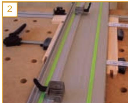
tionen, das ist besonders vorteilhaft wenn mehrere gleiche Werkstücke bearbeitet werden sollen. Legen Sie dazu die Werkstücke wie in Bild 1 auf den MFT, als rechter Anschlag dienen hier zwei Einsteckpuffer der Spannelemente. Die Führungsschiene wird parallel zu den Werkstückkanten ausgerichtet (Bild 2). Zwischen Werkstück und Anschlagsschiene des MFT legen Sie ein Restholz, damit Sie nicht in die Anschlagsschiene
