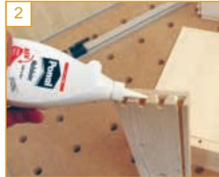
2 versehen und werden ohne Zulagen direkt am Werkstück angesetzt, ohne dabei die Holzflächen zu beschädigen. Zusätzlich drücken sie die Werkstücke noch in den rechten Winkel und flächenbündig zusammen. Geben Sie den Ponal Holzleim an die Flankenflächen der Zinken. Beim Einsetzen der Schwalben
