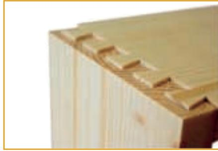
nach oben korrigiert werden, ist die Verbindung zu locker, wird die Frästiefe erhöht. Verwenden Sie dazu die Frästiefeneinstellung. Lösen Sie dazu den Drehgriff-Feststeller um das Motorgehäuse vertikal verschieben zu können. In
