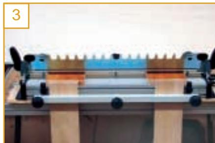
Richten Sie die Splinterhölzer links und rechts an den Seitenanschlüssen und an der Vorderkante des VS 600 aus. Spannen Sie dafür hilfsweise zwei kurze Bretter senkrecht ein.
