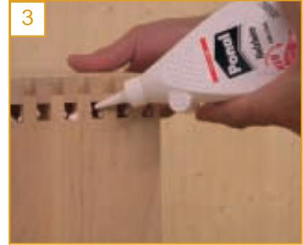
...Leim angeben, er lässt die Zinken aufquellen und da die Verbindung sehr stramm ist, bekommen Sie möglicherweise die Teile nicht mehr zusammen, auch nicht mit Gewalt! Jetzt schnell die Teile zusammenklopfen, verwenden Sie eine Zulage um die Holzoberfläche zu schonen. (Bild 4)
