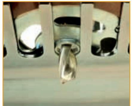
Der Kopierring hat eine geringe Höhe. Heben Sie beim Fräsen auf keinen Fall die Maschine an. Der Kopierring verliert sofort den Kontakt zur Schablone und wird diese beschädigen.
