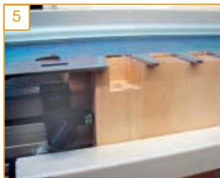
Spannen Sie zunächst ein Probeholz ein. Stellen Sie die Frästiefe ein und fräsen Sie die erste Schwalbe an. Überprüfen Sie jetzt gleich die Frästiefe.
