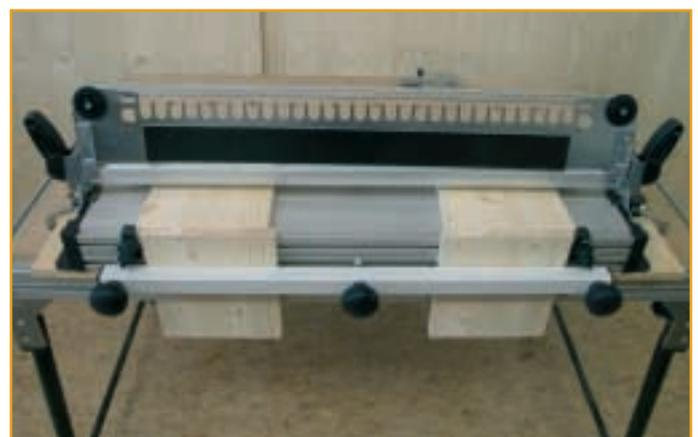
Anschließend werden zwei Werkstücke senkrecht an der Frontseite der VS 600 angebracht. Die Stirnholzflächen der senkrecht stehenden Werkstücke müssen exakt bündig mit den oberen Kanten der waagrecht liegenden Werkstücke zusammen treffen und eine Ebene bilden.
