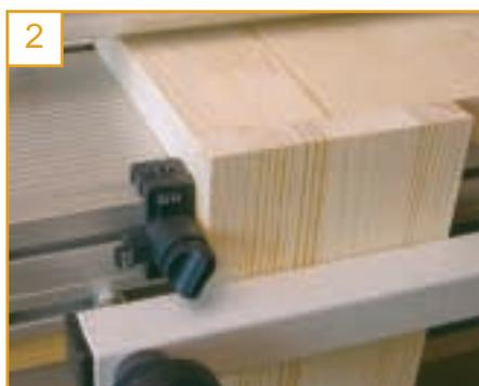
Einspannen der Werkstücke bei Verwendung von Frässchablone FZ 10: Durchgehende Teile werden direkt am Zylinder des Seitenanschlages angelegt. Die obere Brettkante des Werkstückes ist bündig mit der oberen Fläche des Splitterholzes. (Bild 3)
