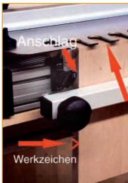
Druckbalken festspannen. Es bleibt bis Ende dieser Fräsarbeit eingespannt. Schablone auf Splitterholz absenken, eben ausrichten und mit den beiden seitlichen Spannhebeln festspannen. Tipp: Legen Sie rechts das zweite Splitterholz unter, welches Sie anschließend beim Zinkenfräsen sowieso benötigen. Dann liegt die Schablone absolut eben auf.
