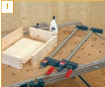
1 Vor dem Verleimen werden die Innenflächen geschliffen. Stecken Sie die Werkstücke zum Überprüfen der Passgenauigkeit trocken zusammen. Legen Sie geeignete Zwingen zurecht und natürlich Ponal Holzleim. Im Bild sehen Sie die UniKlamps von Bessey. Diese Zwingen sind mit Kunststoffbacken
