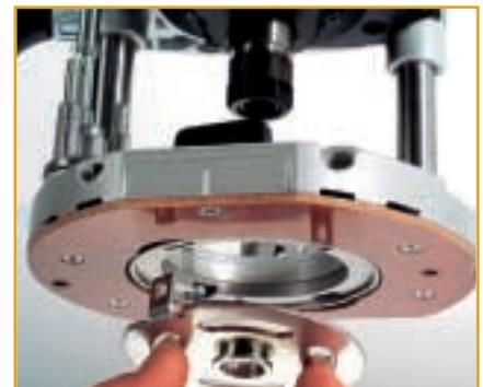
Für die OF 1400 werden spezielle Kopieringe zur Verwendung der VS 600 Frässchablonen angeboten. Bei dieser Oberfräse entfällt das Zentrieren, die Kopierringe werden werkzeuglos montiert und demontiert.
