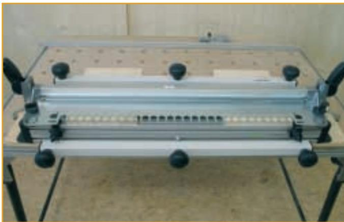
Zur Höheneinstellung der Schablone legen Sie zwei Werkstücke zwischen Grundeinheit und Schablone. Die Werkstücke müssen links und rechts an den seitlichen Anschlägen anliegen. Die Schablone muss absolut eben auf den Werkstücken aufliegen. Drücken Sie die Spannhelme nach oben, damit wird die Schablonenaufnahme in der eingestellten Höhe fixiert. Die Schablone kann jetzt nach oben geschwenkt werden, das erleichtert das Anbringen der senkrecht einzuspannenden Werkstücke an der Frontseite der VS 600.
