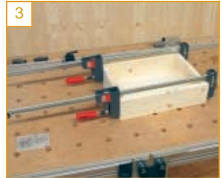
3 wird der Leim verteilt. Achten Sie beim Ansetzen der Zwingen darauf, dass der Zwingendruck durch die Brettachse verläuft, Schräg angesetzte Zwingen erzeugen Scherkräfte und drücken den Korpus aus dem "Winkel". Abschließend noch den Stich messen!
