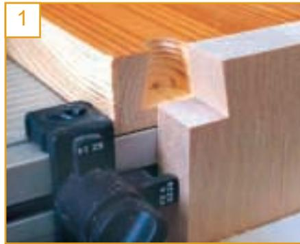
Spannen Sie zunächst ein Probeholz ein. Stellen Sie die Frästiefe ein und fräsen Sie die erste Schwalbe an. Überprüfen Sie jetzt gleich die Frästiefe. Halten Sie ein Restholz (oder das Zinkenstück) an
