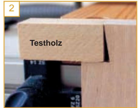
die Ausfräsung. Die Schwalbe sollte nicht mehr als 3/10 mm überstehen, auf keinen Fall darf sie zurückstehen. Korrigieren Sie notfalls die Frästiefe mit der Feineinstellung der Oberfräse.
