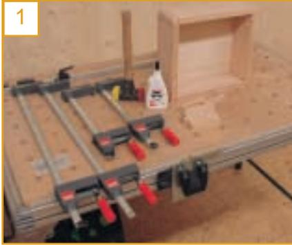
Das Verleimen einer Fingerzinken-Verbindung gestaltet sich im Vergleich zum Verleimen von Schwalbenschwanz-Zinken etwas aufwändiger, da die Zinken vertikal und horizontal in sich zusammen gedrückt werden müssen. Halten Sie also alles bereit was zum Verleimen benötigt wird:
