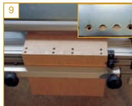
Für Bohrungen ins Stirnholz befindet sich die Schablone in der vorderen Position. Für Dübelverbindungen bei breiteren Werkstücken sind Lochabstände von 32 mm nicht erforderlich, lassen Sie ruhig einen oder zwei Lochabstände aus. Beachten Sie die unterschiedlichen Bohrtiefen für Bohrungen ins Stirnholz und in die Brettflächen.
