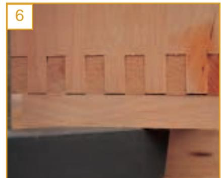
werden Faserausrisse zur Kante hin vermieden. Lassen Sie das Band nicht zu lange auf der Stelle arbeiten, sie schleifen ganz schnell Dellen ins Holz, die Kante wird bauchig, das sieht unprofessionell aus. Ein Rutscher ist aufgrund seiner festen und ebenen Schleifplatte gut geeignet zum Bündigschleifen der oberen und unteren Schmalflächen (Bild 9).
