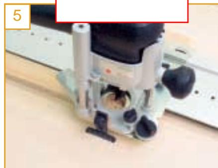
Mit Hilfe der FS-LR32 können auch 35 mm Bohrungen für Topfscharniere passgenau ausgeführt werden
