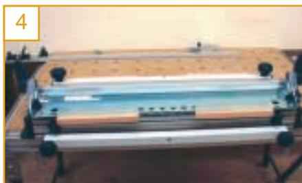
Spannen Sie jetzt ein breites oder zwei schmalere Werkstücke waagrecht auf das Grundgestell. Die beiden Spannhebel (A) für die Höhenverstellung öffnen und die Schablone auf das Werkstück absenken. Achten Sie darauf, dass diese absolut waagrecht aufliegt. Spannhebel wieder schließen.
