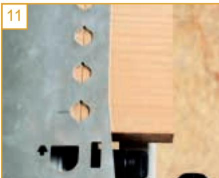
Das Werkstück so unter der Schablone positionieren, dass die Bohrlinie exakt unter den Auskerbungen der Schablone liegt.
