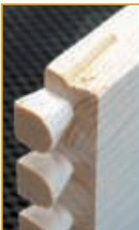
Trotz sorgfältiger Holz Auswahl kann es zu Aussplitterungen kommen wenn, wie beim Fräsen der Schwalben, quer zur Maserung gearbeitet wird. Darf dies nicht passieren, sägen Sie Ihre Werkstücke 23 mm breiter zu, fräsen Sie die Holzverbindung und sägen Sie anschließend die Werkstücke auf die geplante Breite. Aus den abfallenden Leisten können Sie z. B. einen Bilderrahmen fertigen.
