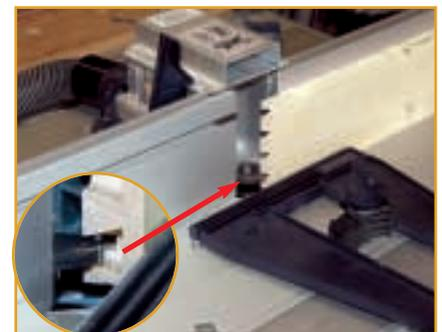
Die Nuten für Schubkastenböden, bzw. Rückwände lassen sich alternativ zur handgeführten Oberfräse schnell und präzise mit der stationären Oberfräse fräsen. Verwenden Sie dazu einen Scheibennutfräser.
