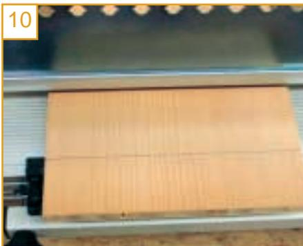
Werkstücke, die Bohrungen in die Fläche erhalten, liegen horizontal auf dem Grundgestell. Die Fläche, in die gebohrt werden soll, liegt oben. Die Bezugskante liegt am Anschlag! Handelt es sich um Seiten, liegt die Außenfläche immer auf dem Grundgestell auf. Mittelseiten können beidseitig Bohrungen erhalten. Bezugskante liegt auch hier immer am Anschlag!
