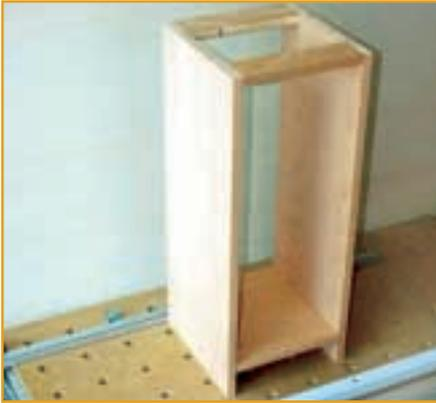
Als praktisches Anwendungsbeispiel wird die Herstellung eines typischen Möbelkorpusses aus furnierter Tischlerplatte mit 19 mm Holzdicke in zwei Varianten dargestellt. Einmal wird als oberer Abschluss ein einliegender oberer Boden verwendet (Bild Mitte links). Alternativ werden z. B. bei Küchenunterschrank als obere Querverstrebung zwei Traversen eingesetzt um Material zu sparen, da hier die Küchenarbeitsplatte aufgelegt und mit den Unterschrank verschraubt wird. (Bild links)
