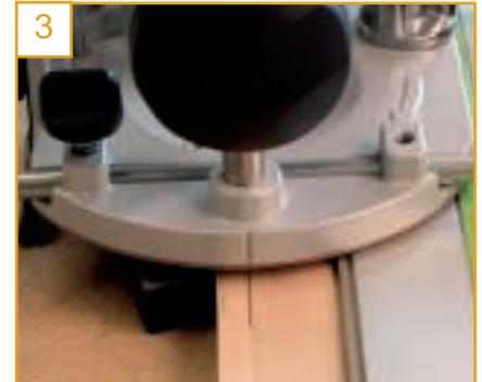
fräsen. Die Fräsposition für die Nutmitte stellen sie an der Mittenmarkierung am Frästisch ein (Bild 3). Die Fräsweglänge zum Einsatzfräsen wird durch zwei auf der Führungsschiene montierten Führungsbegrenzern begrenzt (Bild 4). In Bild 5 ist die durchgehende, in Bild 6 die nicht durchgehende Nut erkennbar.
