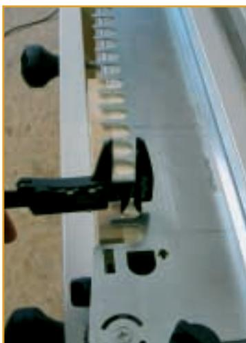
Bild links: Überprüfen Sie bitte (z. B. mittels eines Messschiebers) den parallelen Abstand der Schablone zur vorderen Kante des Grundgestells, hier treffen waagrechtes und senkrecht Werkstück aneinander. Ist dieser Abstand nicht parallel, dann bitte die Schablone ausrichten. Später, bevor die Schablone abgebaut wird, diese auf die Grundeinheit absenken und das entsprechende Einstellrad der Schablone soweit verdrehen, bis dessen Anschlag am Grundgestell anliegt.
