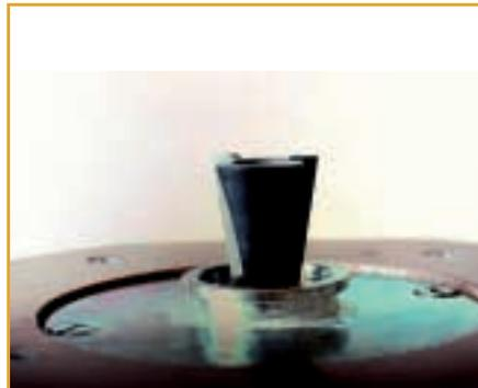
Würde diese während des Fräsens angehoben, könnte der Fräser die Schablone ausfräsen. (Bild links). Setzen Sie anschließend den vorgesehenen Grat-/Zinkenfräser in die Spannzange.
