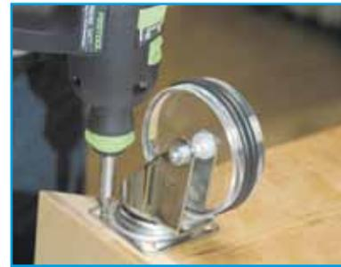
21 Nach dem letzten Ölen Lenkrollen mit dem Akkuschraub-er (C 12) unter die Bodenplatte schrauben.
