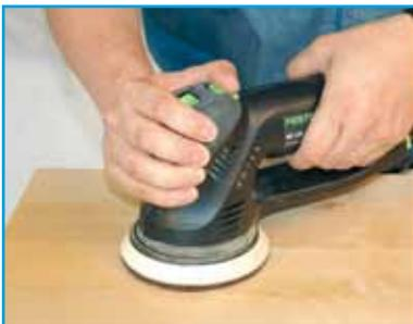
20 Mit dem Rotex und einem feinen Schleifvlies (Körnung P 280) das Öl einschleifen.
