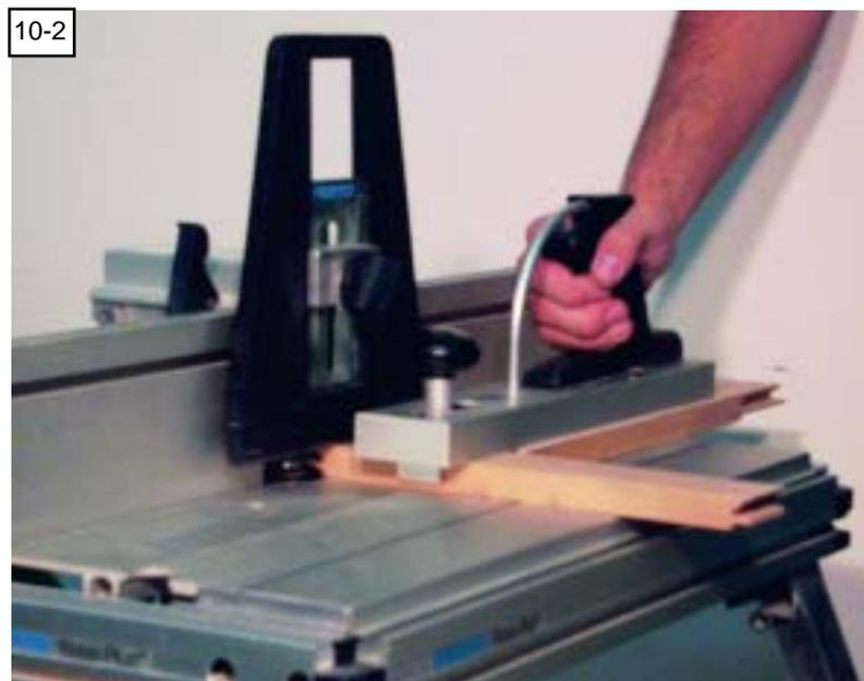
Nachdem an allen Querfriesen das Konterprofil angefräst wurde, wird der Fräser umgebaut.
