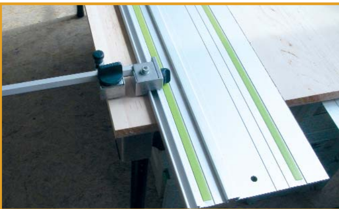
Zwei Seitenanschlätze eignen sich zum genauen Einstellen der Schnittbreite bei Längsschnitten.
