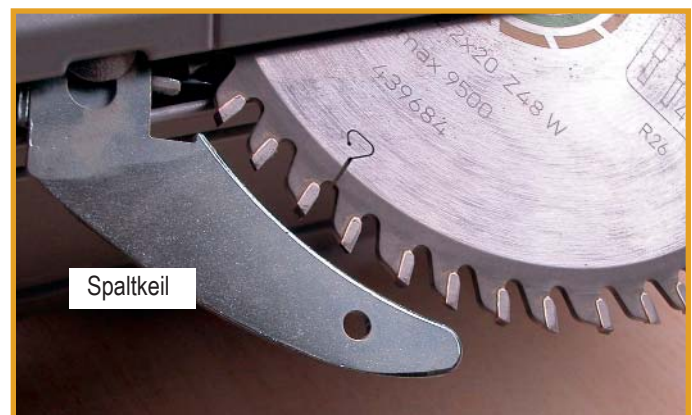
Feinzahn-Sägeblatt für saubere ausrissfreie Schnitte, besonders von beschichteten und furnierten Platten
