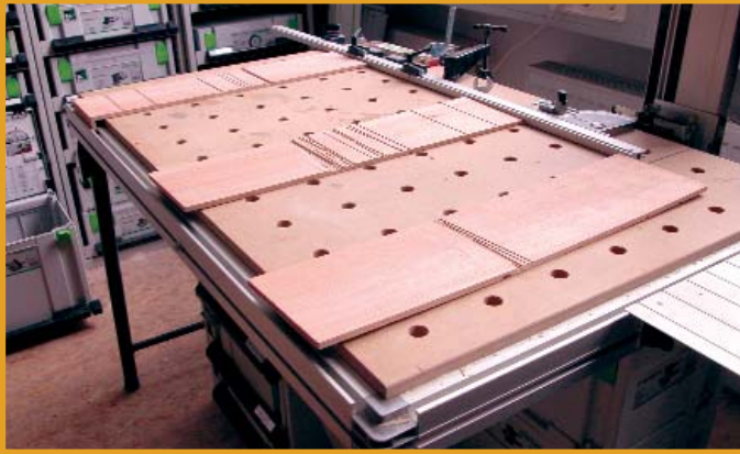
Unterlagen aus Furnierplatte verhindern bei Längsschnitten die Beschädigung der Lochplatte.
