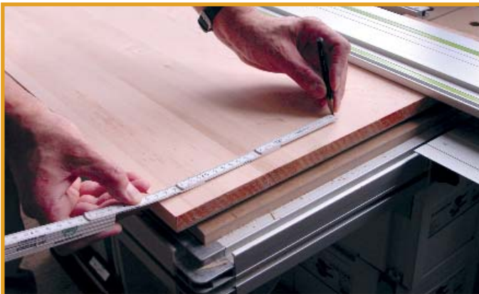
Die Breite des Brettes mit dem Meterstab abmessen und markieren.
