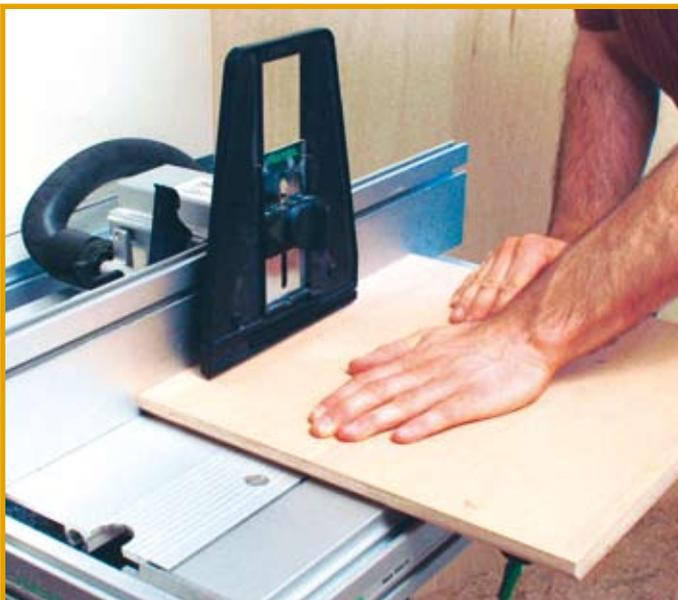
Eine Andrückvorrichtung drückt die Platte während des Fräsvorgangs auf den Maschinentisch. Sie dient gleichzeitig zum Schutz der Hände.
