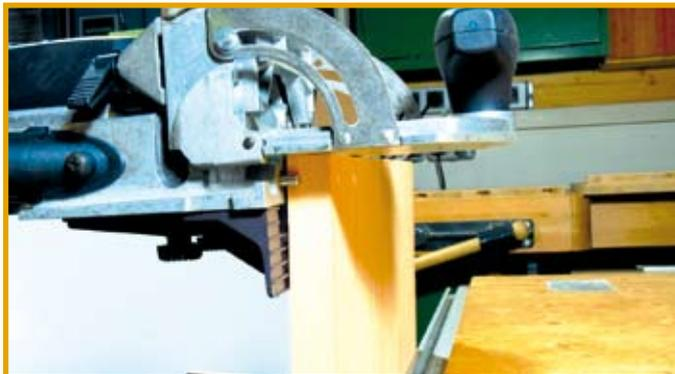
Korpusseite ist senkrecht eingespannt. Der Auflegewinkel verhindert eine Kippen der Maschine.
