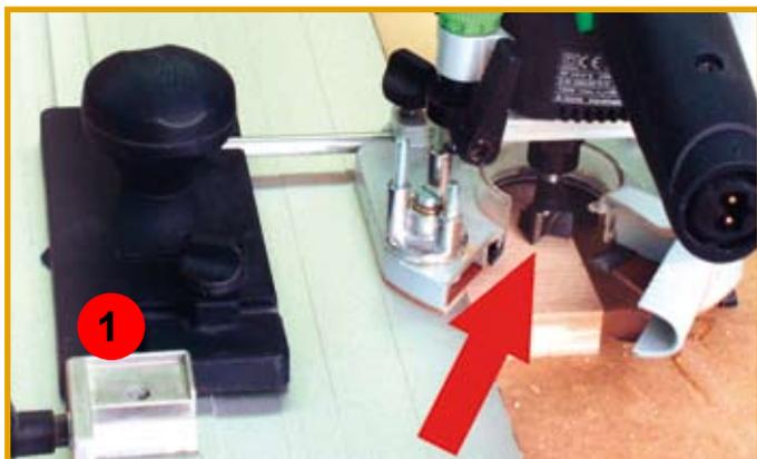
Bohrung für Einschraubdübel.
