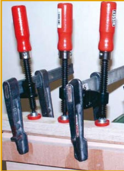
Es können die klassischen Tischlerzwingen in Kombination mit Kantenzwingen verwendet werden. (Bild links)
