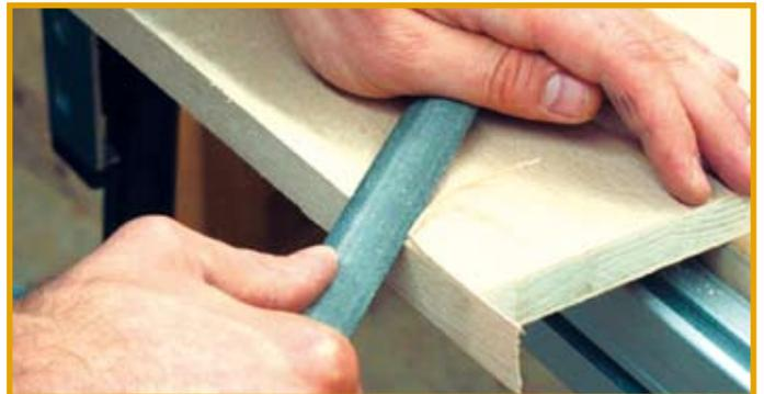
Die überstehenden Enden werden ebenfalls mit der Feile abgetrennt. Führen Sie das Werkzeug rechtwinklig zur Kante, feilen Sie von oben nach unten.
