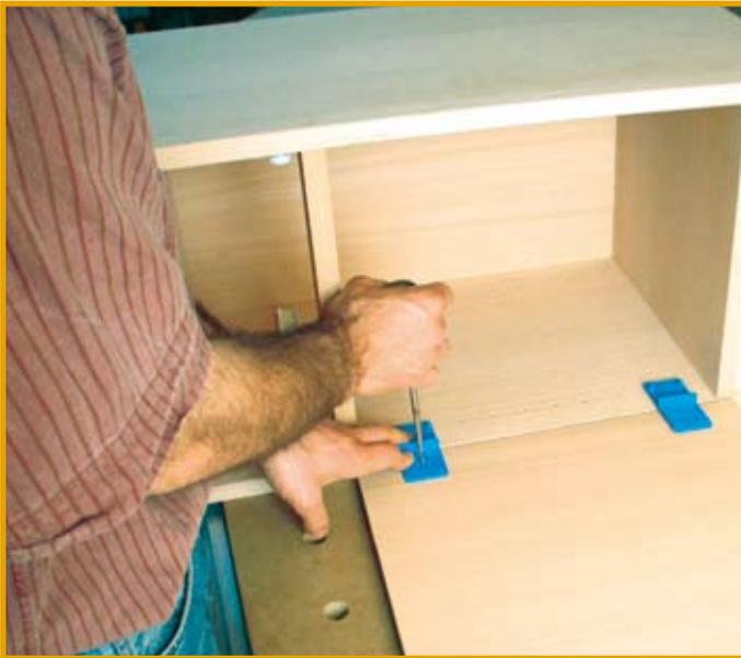
Im nächsten Arbeitsgang werden die Frontelemente bestehend aus Türe und Schubkastenblende montiert. Diese sollten exakt zugeschnitten und mit Kanten versehen sein.
