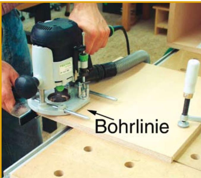
Mit einem Schreinerwinkel wird im rechten Winkel zur Türkante ein Bleistiftstrich gezogen, welcher die Bohrlochmitte der Topfbohrung markiert.
