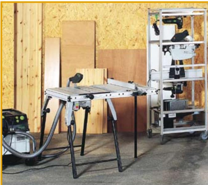
Zum Formatieren kleinerer Teile reicht eine kleine Tischkreissäge z.B. die CS 50 von Festool mit Tischverbreiterung, Tischverlängerung und Schieb-anschlag vollkommen aus.
