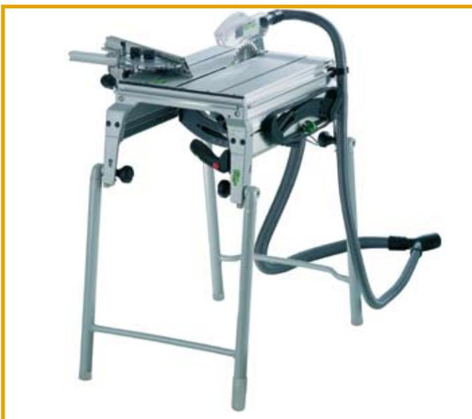
Eine interessante Alternative für die Heimwerkstatt ist die Tischkreissäge "Precisio" CS 50 EB-Set von Festool. Die Maschine ist äußerst präzise, leistungsstark und mobil. Mit einer maximalen Schnitthöhe von 52 mm bei 90° und 37 mm bei 45° Schnitten ist sie für praktisch alle Holzdicken, die beim Heimwerken benötigt werden, gut ausgestattet.
