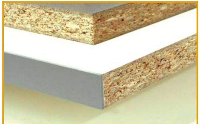
Kunststoffbeschichtete Spanplatten, die Untere ist an der vorderen Schmalfläche mit einer PVC-Kante versehen.
