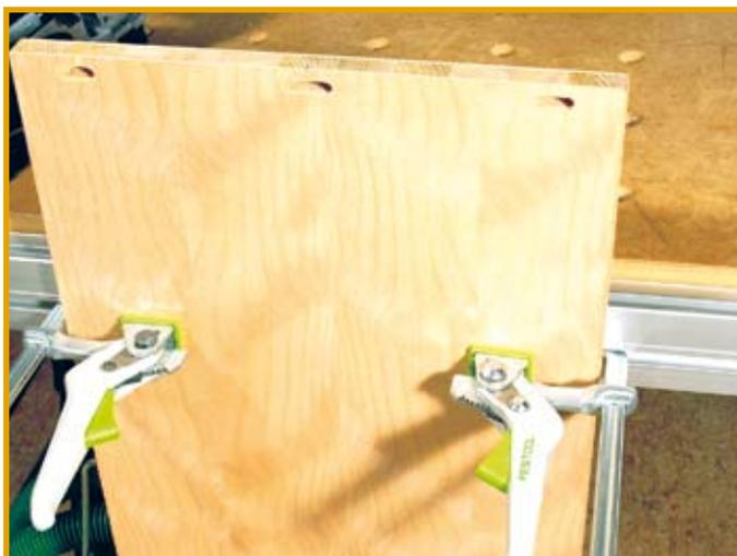
Die fertig gefrästen Langlöcher für die Eckverbindung von Korpusseite und oberem Boden.
