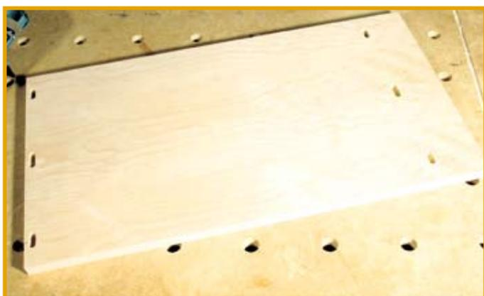
Fertige Langlöcher für die Verbindung von oberem und unterem Boden (oben). Passende Eckverbindung (unten).
