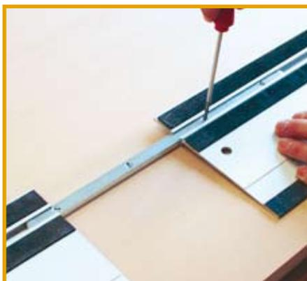
Zum Auftrennen langer Werkstücke können zwei Führungsschienen mit einem Verbindungsstück verbunden werden.
