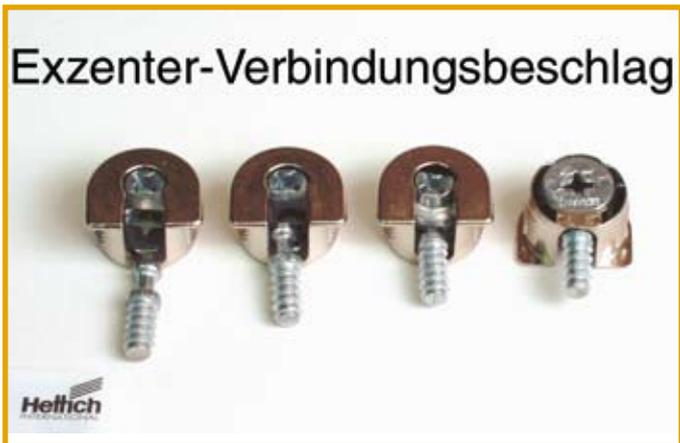
Exzenterverbindungen (siehe auch Seite 13) sind bei zerlegbaren Möbeln die Verbindungsmittel, die am weitesten verbreitet sind. Unser Bild zeigt ein Exzentergehäuse und einen Einschraubdübel. Der Einschraubdübel wird in eine 5 mm Bohrung in der Schrankseite eingeschraubt. Der Schrankboden erhält eine Bohrung Durchmesser 20 mm für das Exzentergehäuse.
