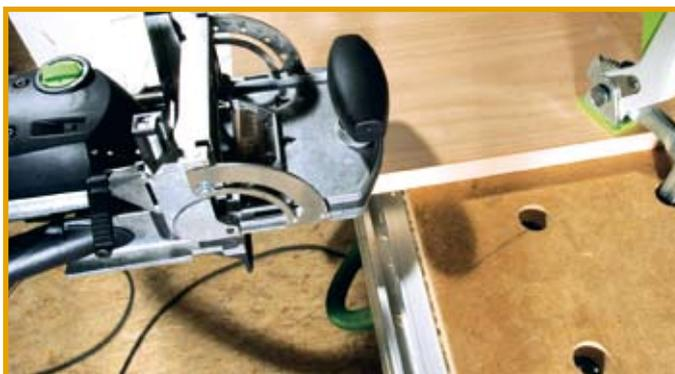
Der obere Boden liegt waagrecht auf dem MFT. (oben) Verbindung des Travers (unten).
