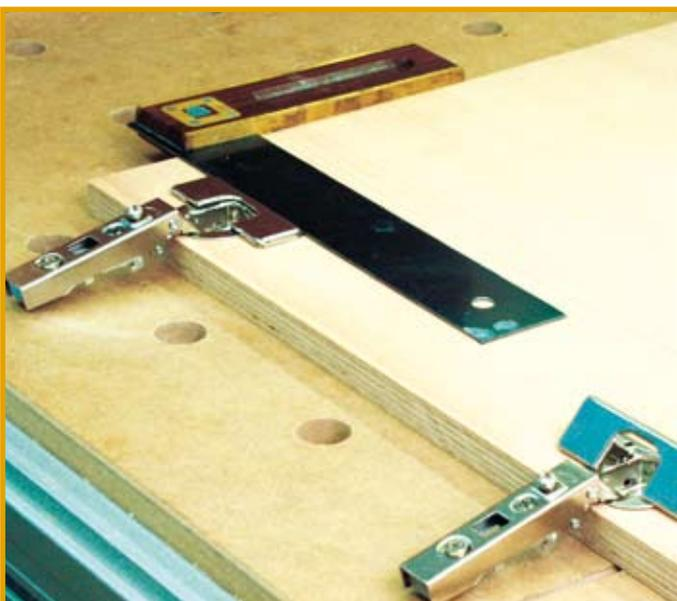
Stellen Sie mit dem Schreinerwinkel sicher, dass die Topfbänder exakt im rechten Winkel zur Türkante sitzen. Die abgebildeten Topfbänder der Firma Hettich werden durch das Herunterdrücken der Metallabdeckung in der Bohrung festgepresst. Das Eindrehen von Schrauben entfällt.
