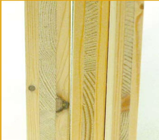
Dreischichtplatten in Nadelholz sind in unterschiedlichen Dicken erhältlich
