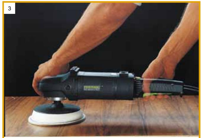
(3) Zum perfekten Polieren von speziellen Lackierungen und anderen Oberflächen z. B. von Schellackpolitur, ist ein Rotationspolierer von großem Nutzen. Er macht sich besonders bei großen Flächen bezahlt, denn hier ist das Polieren eine sehr mühsame Arbeit. Auch hier können mit unterschiedlichen Poliermitteln und Polierpads höchste Oberflächengüten erreicht werden.
