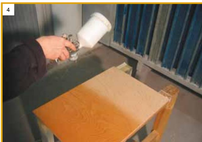
Viele Fehler bei der Oberflächenbehandlung entstehen durch falsche Techniken. Beachten Sie, dass Sie für Lack, Lasur, Öl oder ähnlichem die geeignete Auftragstechnik auswählen. Viele Lasuren oder Öle sind z.B. auf Grund ihres hohen Pigmentgehaltes nicht zum Aufspritzen geeignet, sie müssen mit dem Pinsel oder der Rolle aufgetragen werden. Entnehmen Sie der Gebrauchsanweisung des jeweiligen Mittels, wie Sie es auftragen können. Hier sollen die vier gängigsten Lackiertechniken vorgestellt werden:
