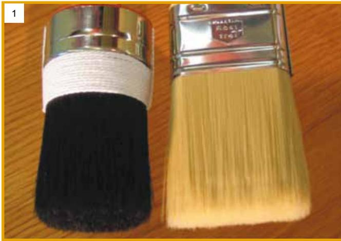
(1) Pinsel aus Natur- oder Chinaborsten (im Bild links) sind besonders für lösemittelhaltige Lacke wie z.B. PUR-, Nitro- oder Kunstharzlacke geeignet. Für wasser- verdünnbare Lacke sowie Lasuren sind Chinaborsten nicht geeignet, da die Borsten beim Kontakt mit Wasser quellen.
