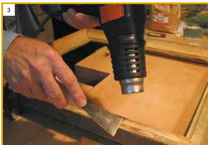
Alternativ können die Lackschichten auch mit einem Heißluftfön abgebrannt werden.
