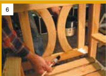
(1) Mit Zweikomponenten Lacken können sehr robuste Oberflächen erzeugt werden
