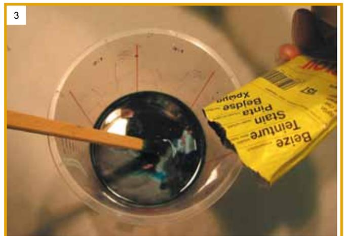
Lösemittelbeizen entwickeln beim Trocknen gesundheitsschädliche Dämpfe. Daher ist für eine anständige Belüftung zu sorgen.
